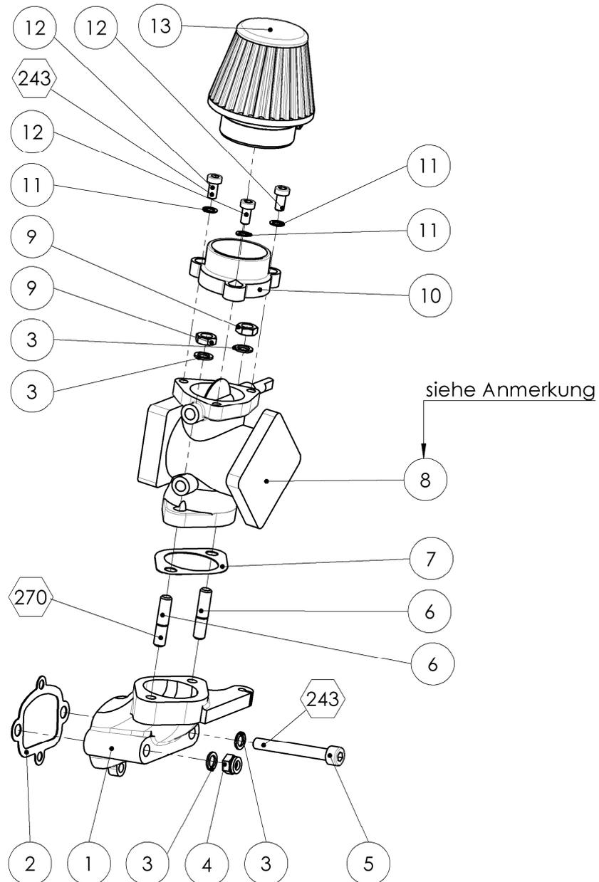
Bild 3 Vergaseranlage-2625-02-Binder-Zünderseite
