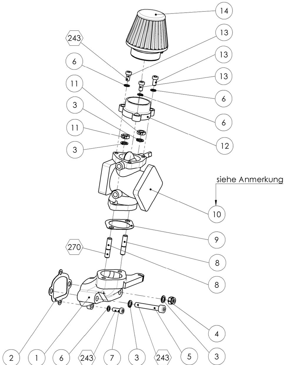
Bild 3 Vergaseranlage-2625-02-Binder-Abtriebseite
