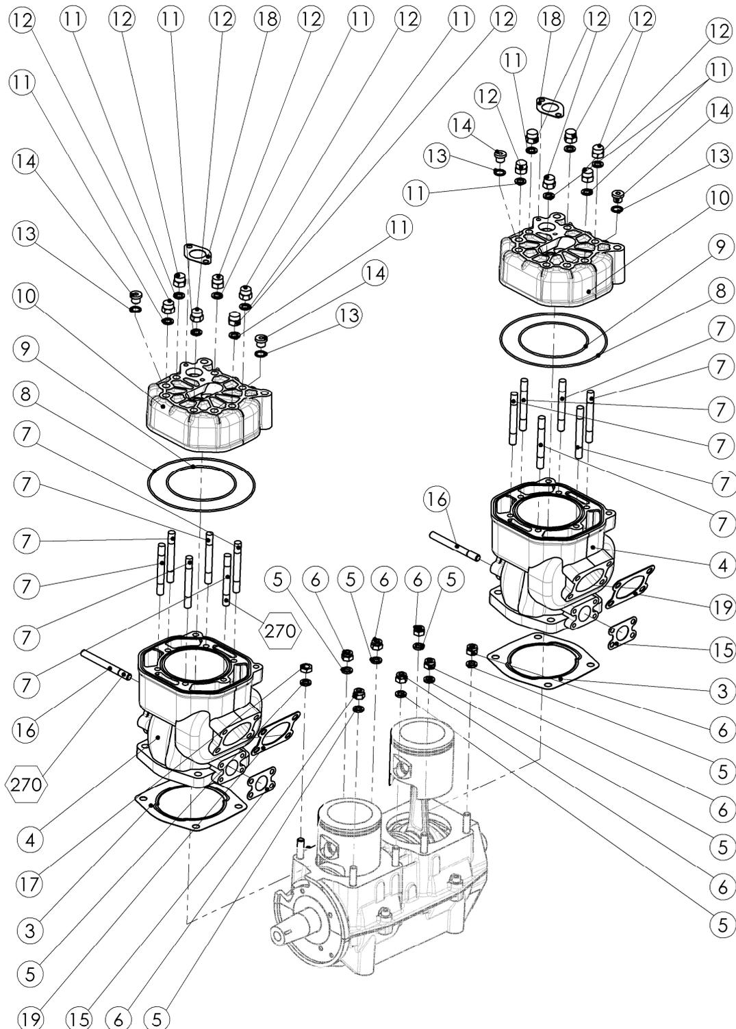
Bild 2 Zylinder-Zylinderköpfe-Kolben-2625 - 01- 02 Binder
